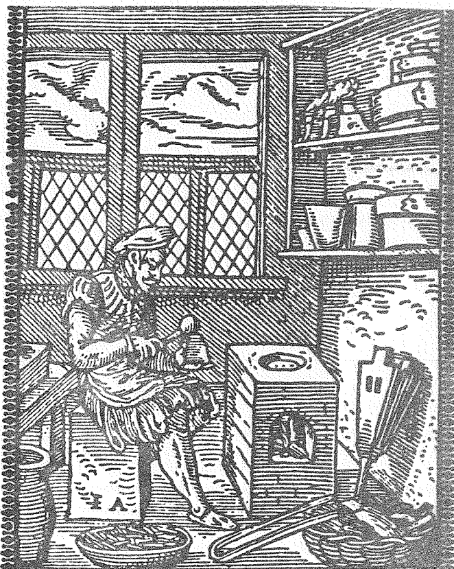
Fundição de caracteres tipográficos (gravura de Jost Ammann, publicada em meados do século XVI na Alemanha).
